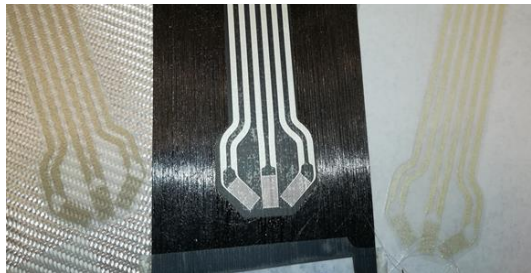
Sensores embebidos en composites
